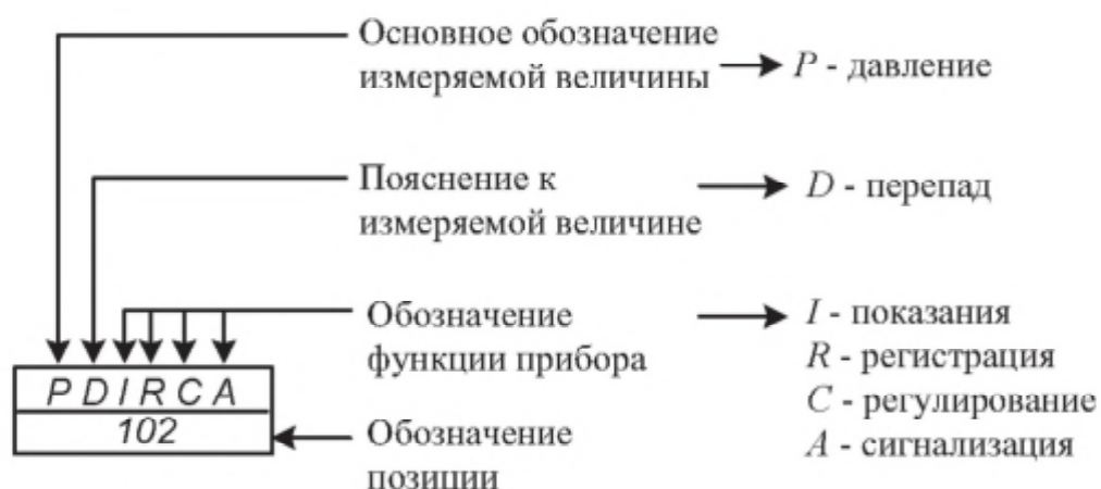
Рисунок 2.10. Пример и расшифровка условного обозначения средства автоматизации
